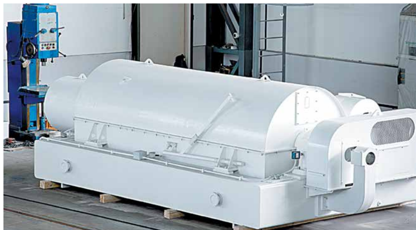
Осадительно-фильтрующая центрифуга «Элемет» для обезвоживания тонких угольных шламов крупностью от 0 до 3 мм.
