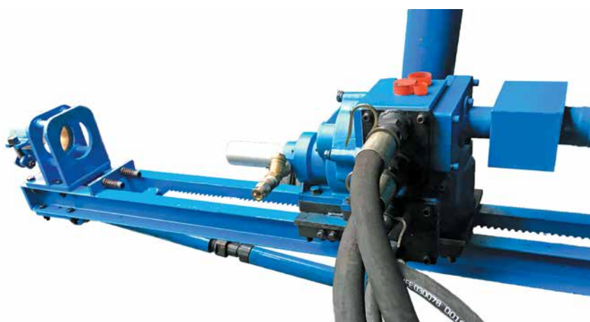
Одностоечный пневматический буровой станок ZQJC-560/10.0
