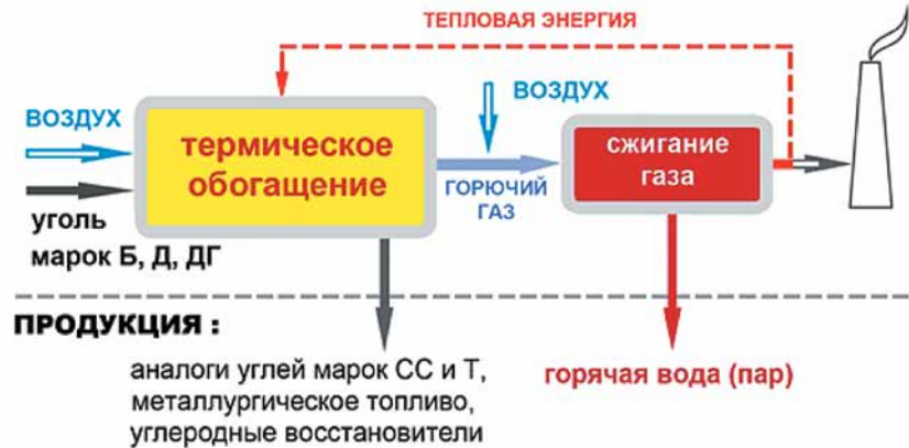
Рисунок 2. Принципиальная технологическая схема термического обогащения угля с высоким выходом летучих веществ
